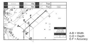
Figure 9.8.0a - Route Check parameters
