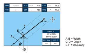
Figure 9.8.0a - Route Check parameters
