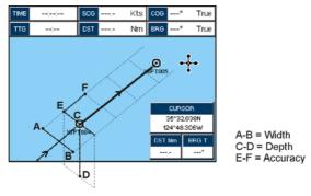
Figure 9.8.0a - Route Check parameters
