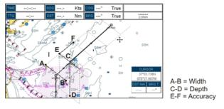
Figure 9.8.0a - Route Check parameters
