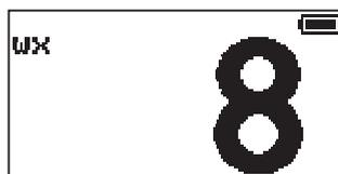
3. Para salir de los canales meteorológicos NOAA, pulsar la tecla [MENU/SET] para visualizar la pantalla de MENÚ y a continuación pulsar la tecla de función [CH]. El transceptor volverá al canal que estaba en uso antes de conmutar al modo canal meteorológico.
