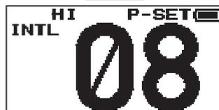
4. Para volver al canal de funcionamiento anterior, pulsar una de las teclas de función, y a continuación pulsar la tecla de función [P-SET]. El icono "P-SET" desaparece de la pantalla.
