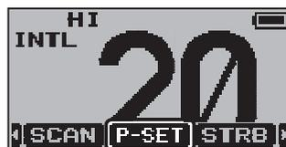
3. Pulsar la tecla de función [P-SET] y a continuación pulsar las teclas [▲] o [▼] para seleccionar el canal preconfigurado a borrar.
