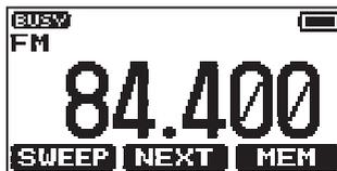
3. Para salir del modo de recepción de emisiones FM, pulsar la tecla [MENU/SET] para visualizar la pantalla de MENÚ y a continuación pulsar la tecla de función [CH]. El transceptor volverá al canal que estaba en uso antes de conmutar a la banda de emisión FM.
