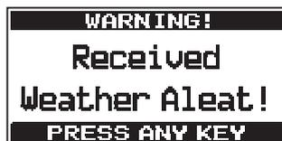
Después de que se detenga el sonido del pitido, aparecerá la pantalla de confirmación de recepción de la alerta meteorológica. Pulsar cualquier tecla para visualizar la pantalla de confirmación. La pantalla de confirmación preguntará si deseamos pasar al canal meteorológico, o volver al canal marítimo. Pulsar [YES] para conmutar al canal meteorológico, o pulsar [NO] para volver al canal marítimo.
