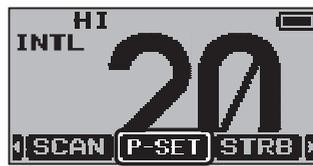
3. Pulsar la tecla de función [P-SET], a continuación pulsar las teclas [▲] o [▼] para seleccionar el canal preconfigurado deseado.
