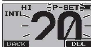
5. Pulsar la tecla de función [DEL] para borrar el canal del canal de memoria preconfigurado.
