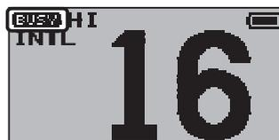
3. Pulsar la tecla [**VOL-**] o la tecla [**VOL+**] hasta que se oiga el ruido o el audio del altavoz a un nivel confortable.
