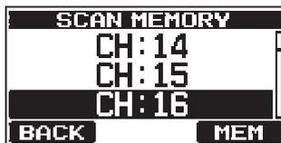
Para comprobar los canales a escanear, pulsar las teclas **[▲]** o **[▼]** repetidamente, para visualizar cada canal. El icono "MEM" aparecerá cuando se visualice un canal de memoria designado.
