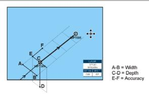
Figure 9.8.0a - Route Check parameters
